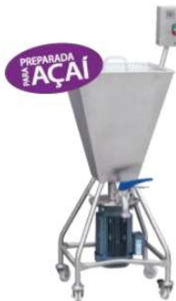
A extração do produto triturado é feita por uma tubulação, fabricada em aço inox 304, na parte inferior, de 2" polegadas, com registro sanitário e conexões com rosca.
