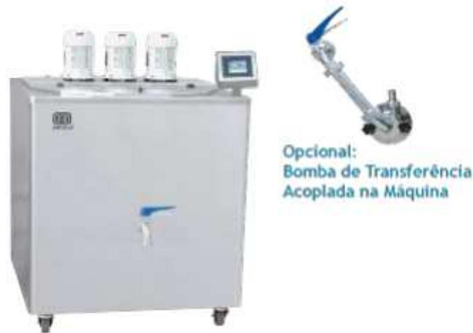
Base com rodízios giratórios de 4 polegadas, com freio. Estrutura e revestimentos construídos em aço inox 304.
